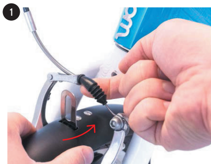
1 podnieś linkę hamulca i wsuń błotnik
