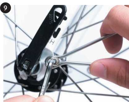
9 dokręć, z lewej i prawej strony, wsporniki śrubą c używając klucza A
