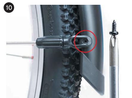
10 wkręć, z lewej i prawej strony wkręty g używając śrubokręta E
