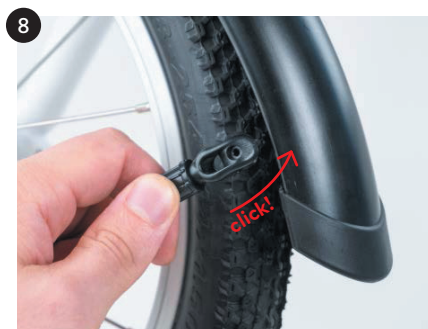
8 wsuń mocowanie z lewej i prawej strony błotnika
