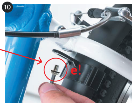
używając klucza A połącz mocowanie łotnika śrubą e z ramą
