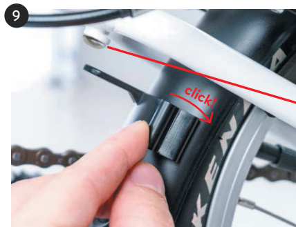
wsuń mocowanie i następnie wykręć śrubę e z ramy
