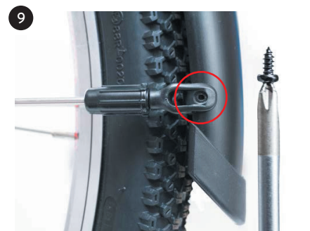
9 wkręć, z lewej i prawej strony wkręty g używając śrubokręta E
