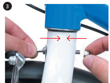
3 śrubę k wsuń w widelec i dokręć nakrętkę h
