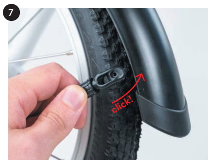
7 wsuń mocowanie z lewej i prawej strony błotnika
