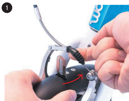
1 podnieś linkę hamulca i wsuń błotnik
