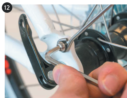
z obu stron, dokręć wsporniki śrubą c używając klucza A
