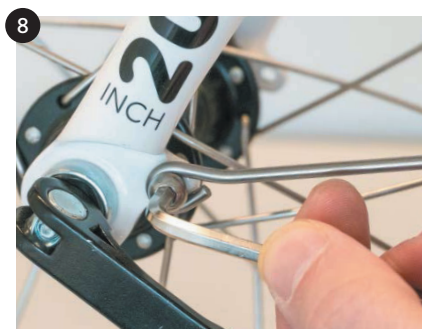
8 dokręć, z lewej i prawej strony, wsporniki śrubą c używając klucza A
