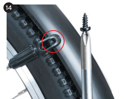
wkręć, z lewej i prawej strony wkręty g używając śrubokręta E
