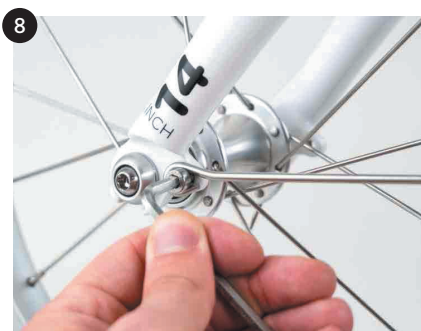
przykręć wspornik z obu stron używając klucza A
