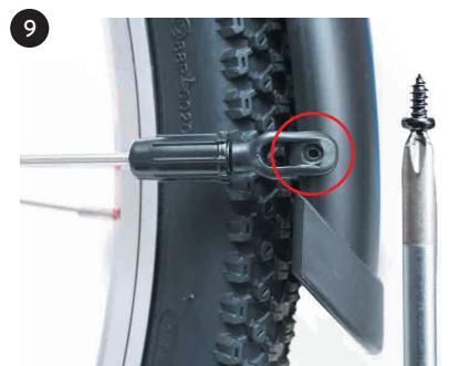
wkręć wkręty z obu stron używając śrubokręta D
