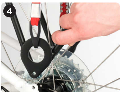
4 Ustaw otwory w bagażniku i ramie w jednej linii
