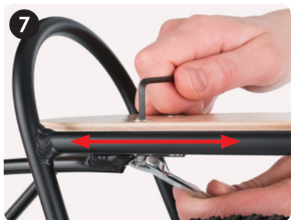
7 Kluczami A + C ustaw bagażnik w prawidłowej pozycji
