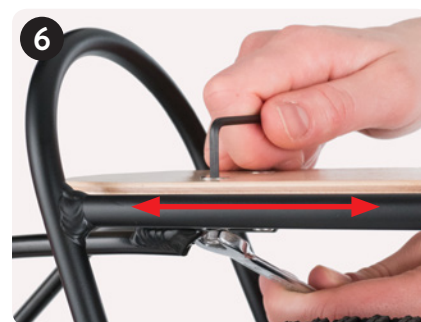
6 Kluczami A + C ustaw bagażnik w prawidłowej pozycji
