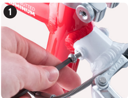
1 Wykręć śruby z obu stron używając klucza B
