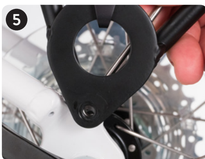
5 Ustaw otwory w bagażniku i mocowaniu błotnika w jednej linii
