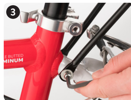
3 Użyj klucza B aby wkręcić c + d z obu stron
