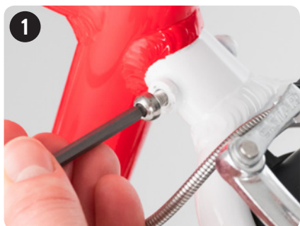
1 Wykręć śruby z obu stron używając klucza B
